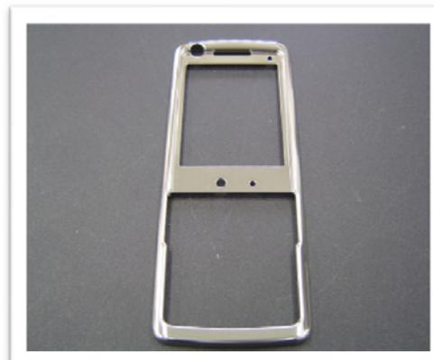
エッチング加工→フォーミング加工→溶接加工等
